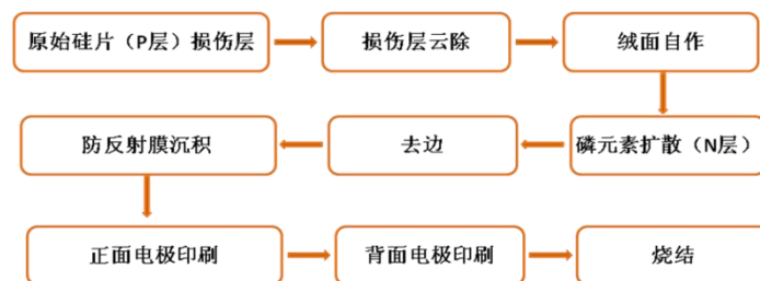
图 3-2-3-19 光伏电池生产流程
